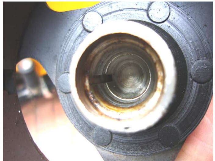
Innenseite des Polrads mit Einkerbung
